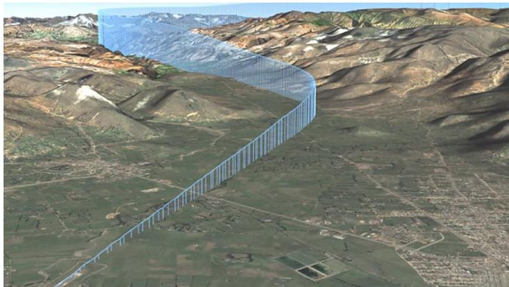
**Abbildung 51: Beispiel eines Flugverfahrens mit Navigationsverfahren RNP1 und RF-Legs**<sup>228</sup>
