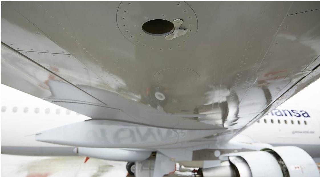
**Abbildung 63: Ein Wirbelgenerator an der Tankdruckausgleichsöffnung montiert ©UNH<sup>337</sup>**
